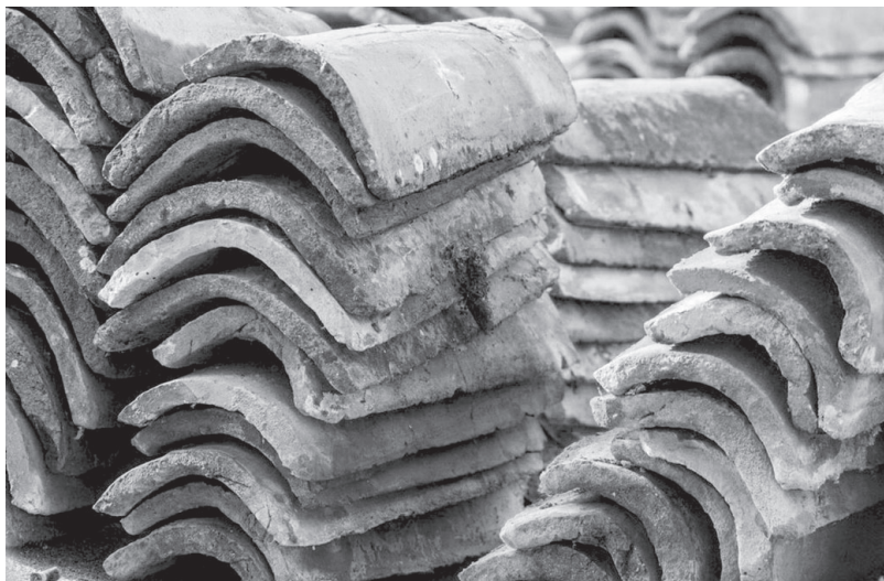
Figura 1. Tegole di recupero dalla copertura della Basilica di Sant'Andrea Apostolo a Mantova [Fonte: impresedilnews.com].
