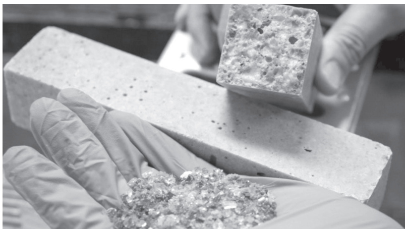
Figura 4. Provino in calcestruzzo con inserimento di vetro riciclato in sostituzione di aggregati fini. [Concretenews, 2019].
