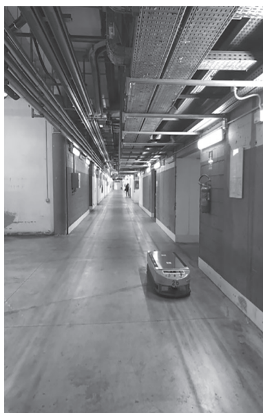
Figura 2. A sinistra: tecnologia di movimentazione AGV per il materiale pesante presso l'Ospedale Papa Giovanni XXIII di Bergamo. A destra: Sistema di trasporto di materiale sospeso e direzionato da binari presso l'Ospedale Universitario di Aachen (D) [Foto dell'autore].
