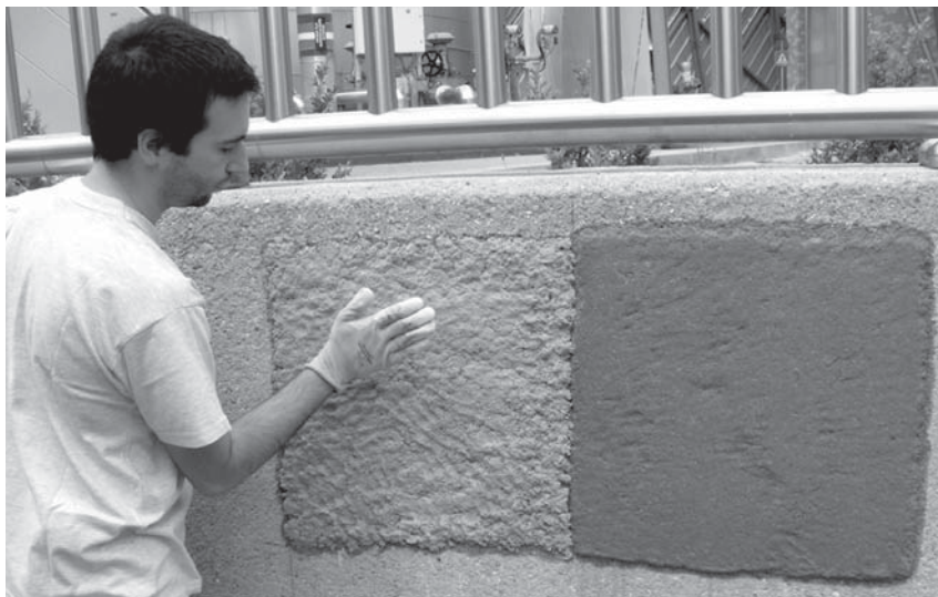
Figura 5. Sperimentazione di +paper, un intonaco isolante in argilla o calce più carta.
