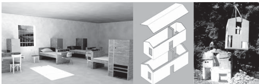
Figura 2. Riqualificazione dell'involucro: sistema tecnologico adottato.
